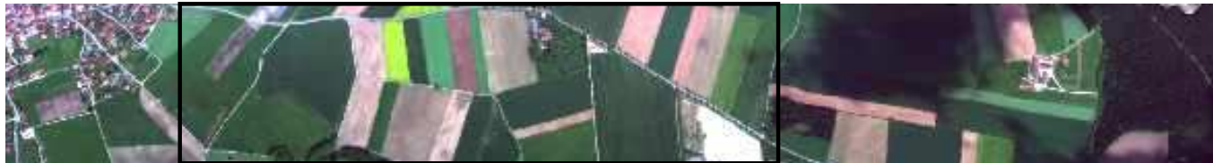
Geometrische Korrektur (durch GPS- und INS-Aufzeichnungen werden AVIS Daten automatisch georeferenziert).
